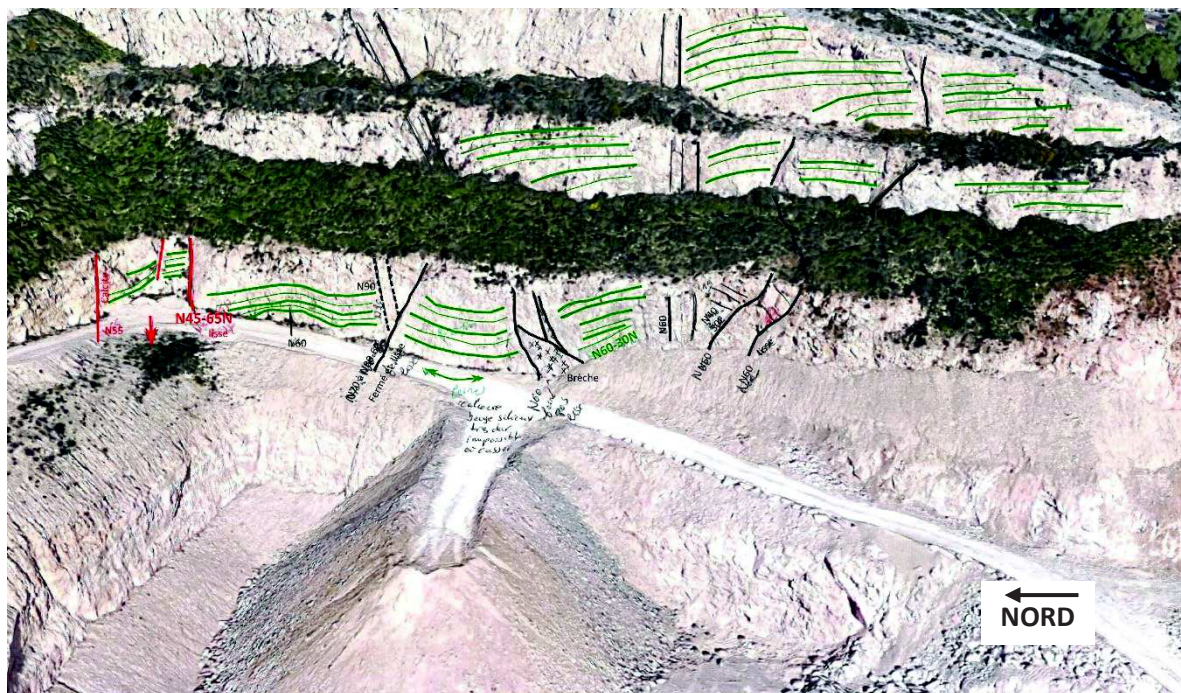
Figure 4 : Ondulation de la stratification dans les fronts Est de la zone S4
