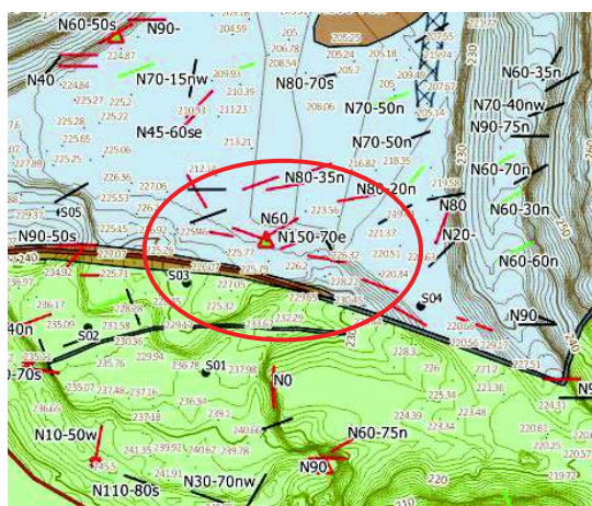
Figure 22 : Plan de faille parallèle au front d’exploitation et penté vers le Nord.
