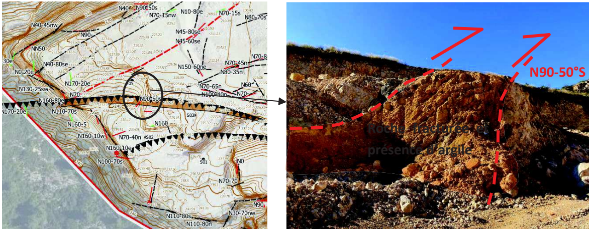
Figure 15 : front très altéré avec le passage du plan de chevauchement
