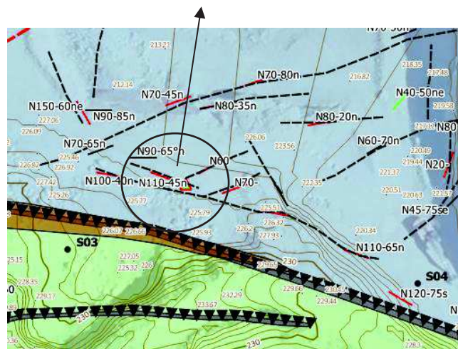
Figure 11 : Plan de faille argileux = plan de glissement potentiel
